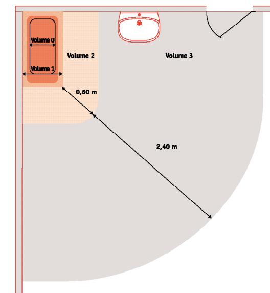
Il est rappelé qu'un dispositif de coupure omnipolaire conformément à la norme NFC 15.100 est obligatoire. La distance de séparation des contacts doit être d'au moins 3mm. Dans une salle de bain ou de douche, veillez à protéger la ligne électrique par un dispositif différentiel haute sensibilité 30 mA.
