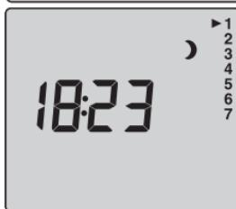
Pour mettre le chauffage en Confort pour une durée indéterminée.
