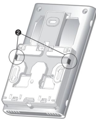
Si nécessaire, des cloisons défonçables (②) avec une pince sont prévues pour laisser passer les câbles de raccordement si nécessaire.
