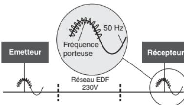
Le protocole DELTA DORE X2D répond à la norme NF-EN50065-1 qui permet la coexistence de plusieurs systèmes CPL, répondant à cette norme, sur une même installation.
